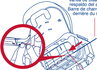
Fig. 2 Hinge rod retainer Sujetador de la vara de la bisagra Dispositif de retenue de la tige de support
